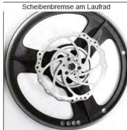
Scheibenbremse.. – frein à disque au volant
