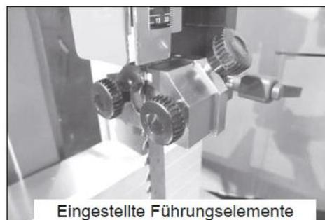
Spannung ... - tension des guides-lames latéraux
